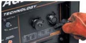
La salida cambia al modo remoto cuando es conectado un dispositivo remoto. Para el **NEW** CC con electrodo revestido, tubería en descendente y Touch Start TIG®, el dial de la máquina se convierte en un límite máximo sintonía fina con el dial de control remoto o Amptrol™
